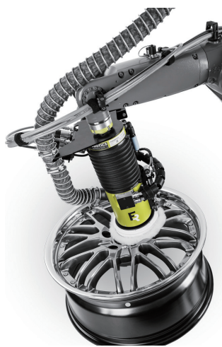
ホイールのような曲面形状のワークに対しても圧力を一定の値に保てる
