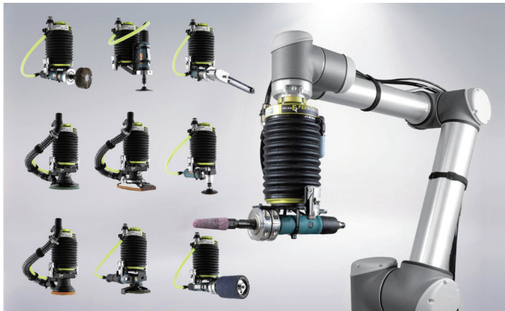
ファーロボティクス社のエンドエフェクタと柳瀬のサンダー・グラインダーを組み合わせた10種類のキットを用意
