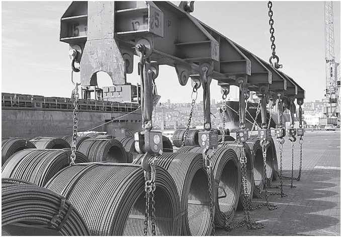
重量のある線材を複数のオート開閉フックで一気に玉掛け外し
